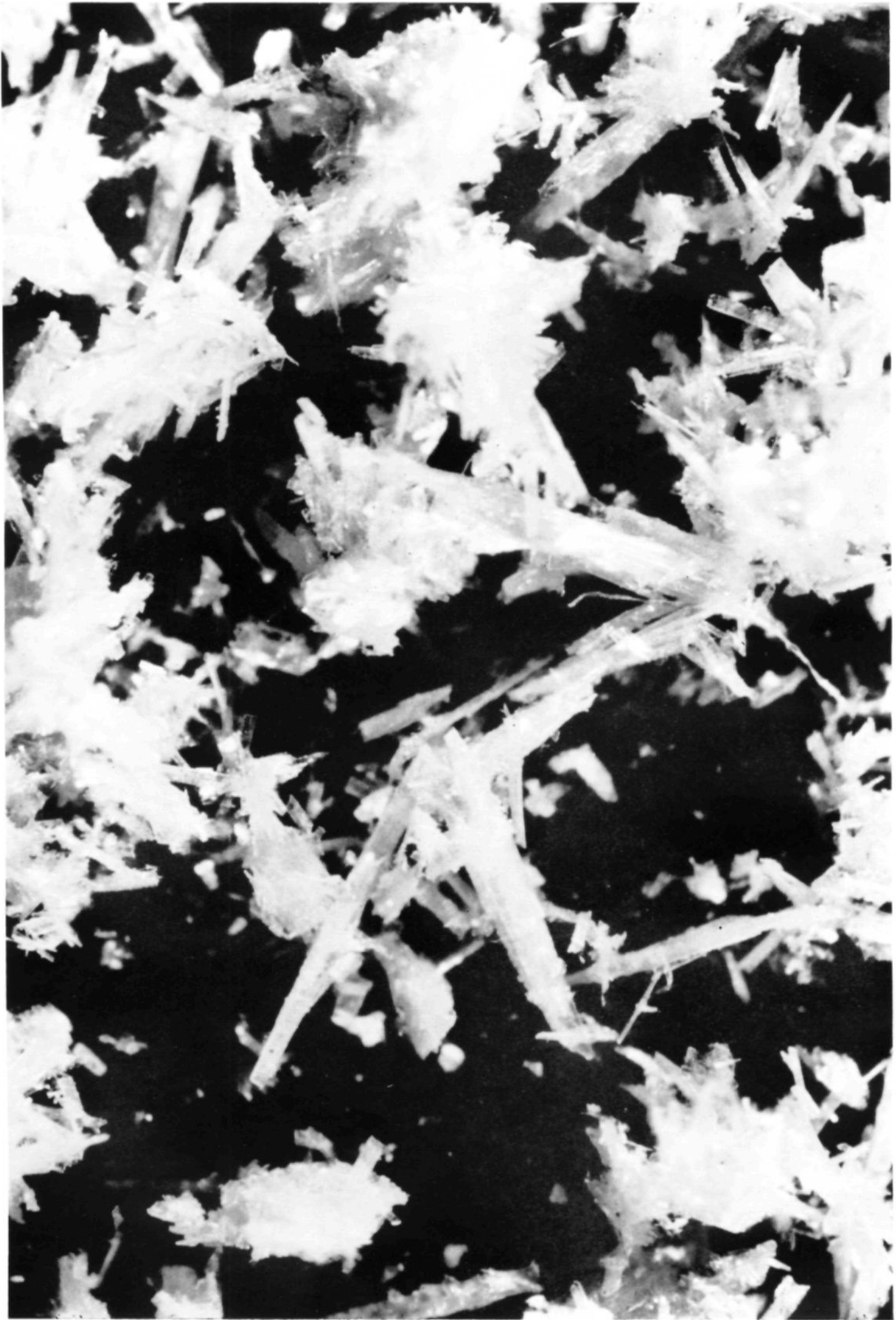
Fig. 2.—Crystals of vitamin A(MeOH), m. p. 7-10°, \times 48 .
